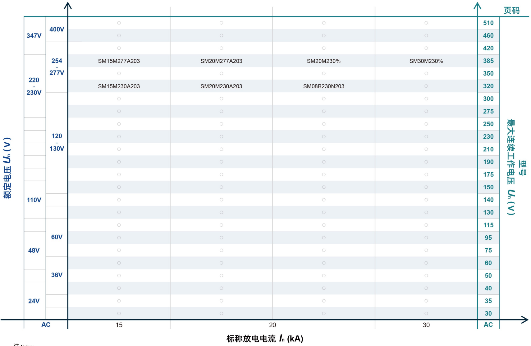
电涌保护模组 (SPD-M) 特性与型号概览
